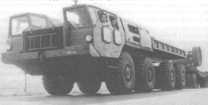
Фото 16. Автомобиль-тягач МАЗ-543П ранних выпусков — отсутствуют противотуманные фары, большие боковые окна, круглые зеркала заднего вида. 1967-1968 гг.
